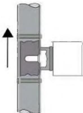
Отсутствие движущихся частей, тне требующий ремонта, простота установки, один модель применимый для различных диаметров труб. Двухпозиционное измерение плавно регулируется, низкие потери давления, компактные структуры. Дисплей LED показывает текущие тенденции и состояния переключения.
